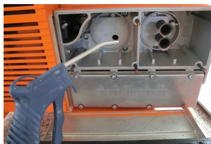
Рис. 50: Очистка фильтрующих патронов
