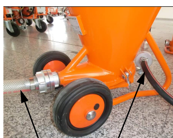
Рис. 15: Присоединение подающего рукава
