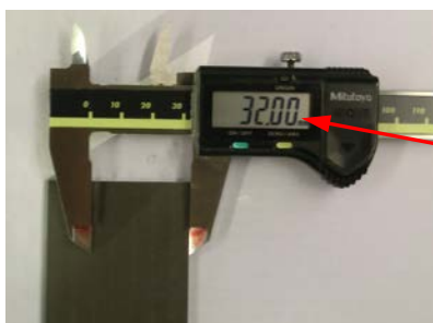
Рис. 51: Контроль ширины шибера
