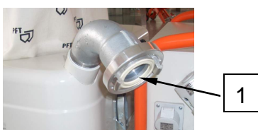
Рис. 15: Присоединение подающего рукава
