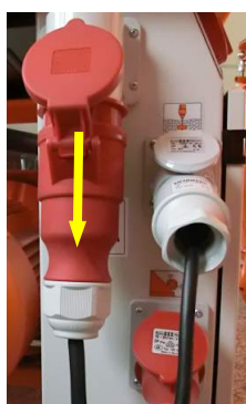
Рис. 30: Прерывание подачи электропитания
