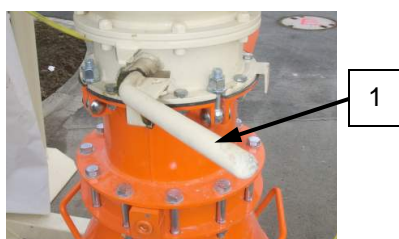
Рис. 39: Закрытие выпускной заслонки хранилища
