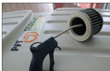
Рис. 50: Очистка фильтрующих патронов
