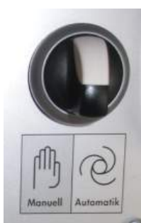
Рис. 54: Переключатель «Ручной» — «0» — «Автоматический»
