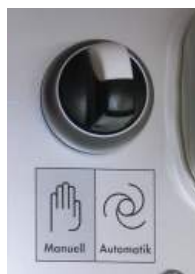
Рис. 8: Режимы работы воздушного компрессора
